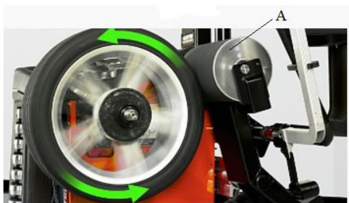
Рисунок 2 - Тестування колеса навантаженням: - А - навантажувальний ролер
