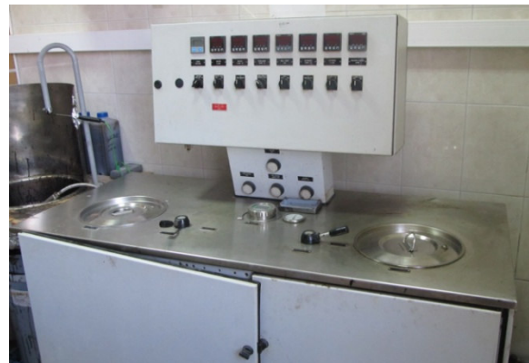
Рис. 1. Лабораторна бітумно-емульсійна установка SEP-0,3R датської компанії «Денімотех»
