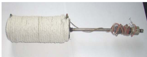
Рис. 3. Схема и фото гидридного патрона, подготовленного к эксперименту: 1 – гидридный патрон; 2 – терморезистор; 3 – электроизоляционная слюда патрона; 4 – нихромовая спираль; 5 – асбестовый шнур; 6 – силовой электрокабель; 7 – асбестокартон; 8 – интерметаллид; 9 – вентиль баллона
