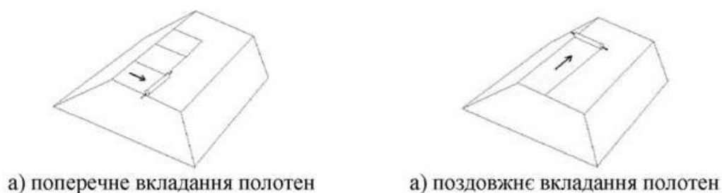
Рисунок 2 – Схеми укладання полотен при армуванні
