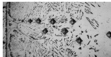
Рис. 3. Микроструктура упрочненного слоя после металлизации Cr и азотирования, \times 500
