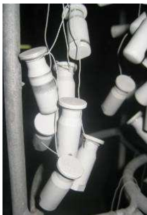
Рис. 1. Детали-ролики из улучшаемой стали 40Х
