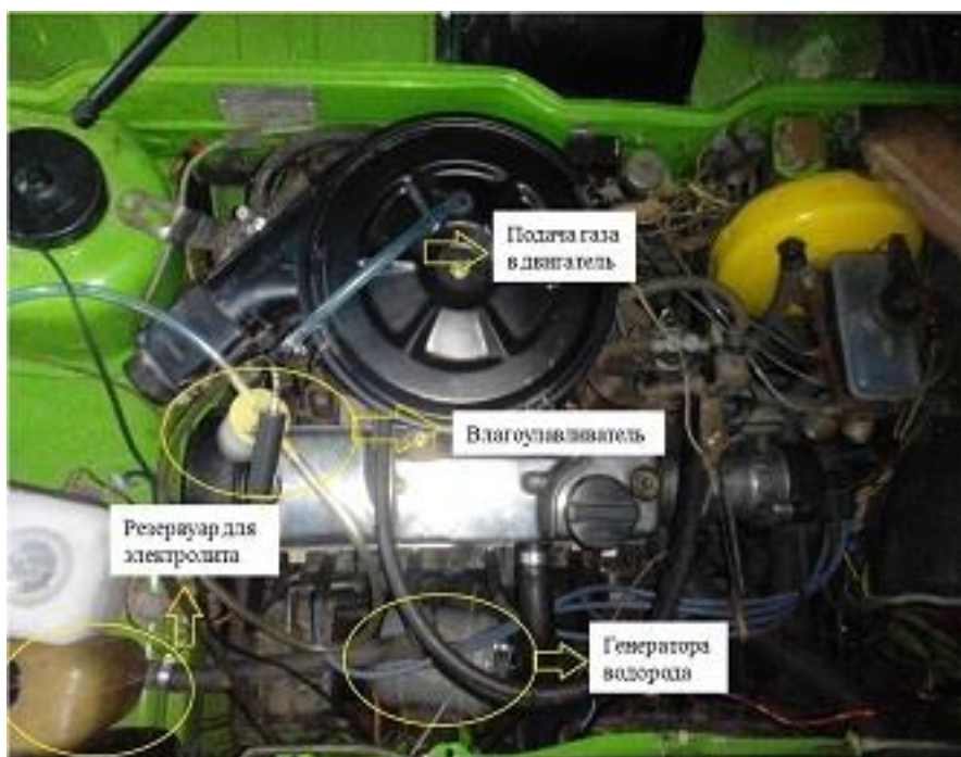
Рисунок 1 - Генератор водню з «мокрими» пластинами, встановлений на експериментальному автомобілі ВАЗ-2109
