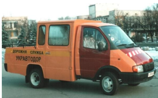
Рис 2. Специальный микроавтобус «Сула», г. Лубны с отштампованными на прессе ПЭГ-ХАИ-500 передней и задней частью крыши, арками колёс и угловыми участками будара ( а ), автобус марки «Эталон» г. Борисполь с угловыми передними и задними участками крыши ( б )
