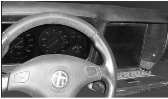
Рис. 1. Установленный компьютер в модернизированной торпеде автомобиля ВАЗ 2101
