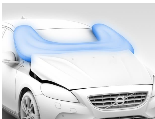
Рисунок 1.3 – Подушки та спеціальний капот, що захищають пішохода
