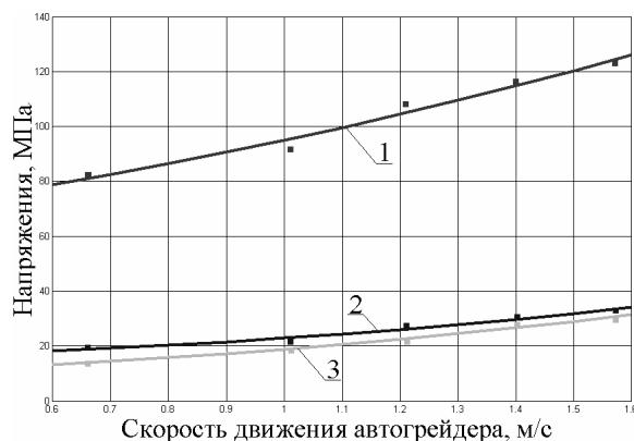
Рис. 3. Влияние начальной скорости движения автогрейdera на нормальные напряжения: 1-зона крепления поворотного узла гидроцилиндров подъема-опускания основного отвала; 2-зона изгиба хребтовой балки; 3-передняя часть лонжеронов подмоторной рамы
