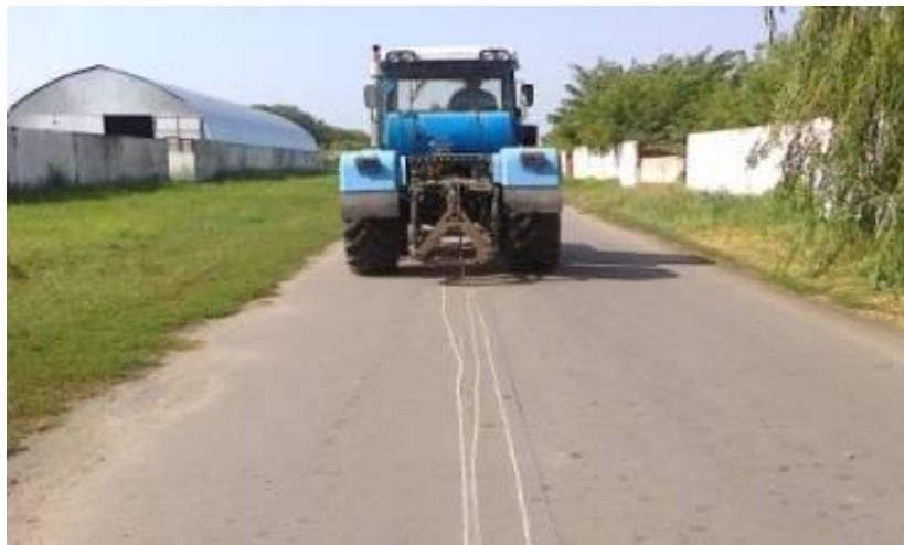
Рисунок 5 – Визначення курсової стійкості трактора ХТЗ-17221
