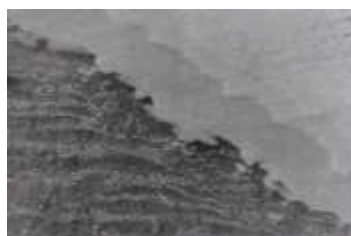
Рис. 2. Дифузійна зона з'єднання платина-титан ( T_{зв} = 1138K , P_{зв} = 6.37 МПа, \tau = 2700 с, х4000)
