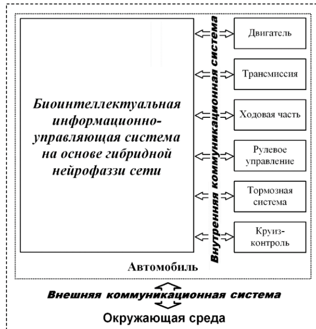
Рис. 1. Пример структурной схемы бортового информационно-коммуникационного комплекса на основе биоинтеллектуальной информационно-управляющей системы
