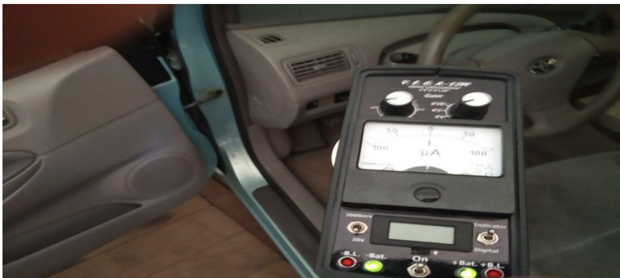
Рис. 29. Вимірювання напруженості ЕМП у середині автомобіля (праве переднє сидіння пасажирів)
