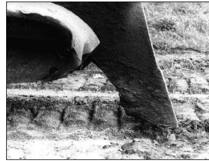
Рис. 2. Формування ґрунтового ядра ущільнення на ножі кабелеукладача традиційної конструкції
