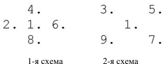
Рисунок 3 – Схемы расположения 5 точек при расчете таблиц МРБ в ячейке 3 на 3 пикселя
