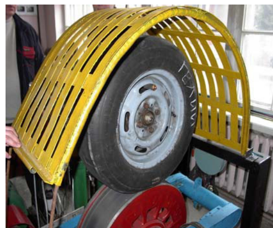
Рис. 2. Крепление колеса на подвеску стенда
