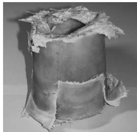
Рис. 5. «Катастрофическое» разрушение образца
