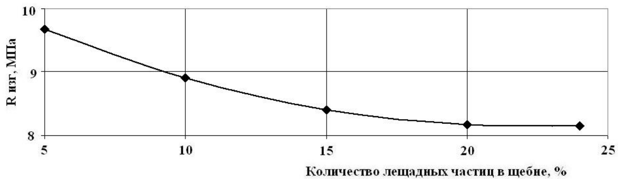
Рис. 2. Прочность при изгибе образцов-балочек с различным содержанием лещадных частиц
