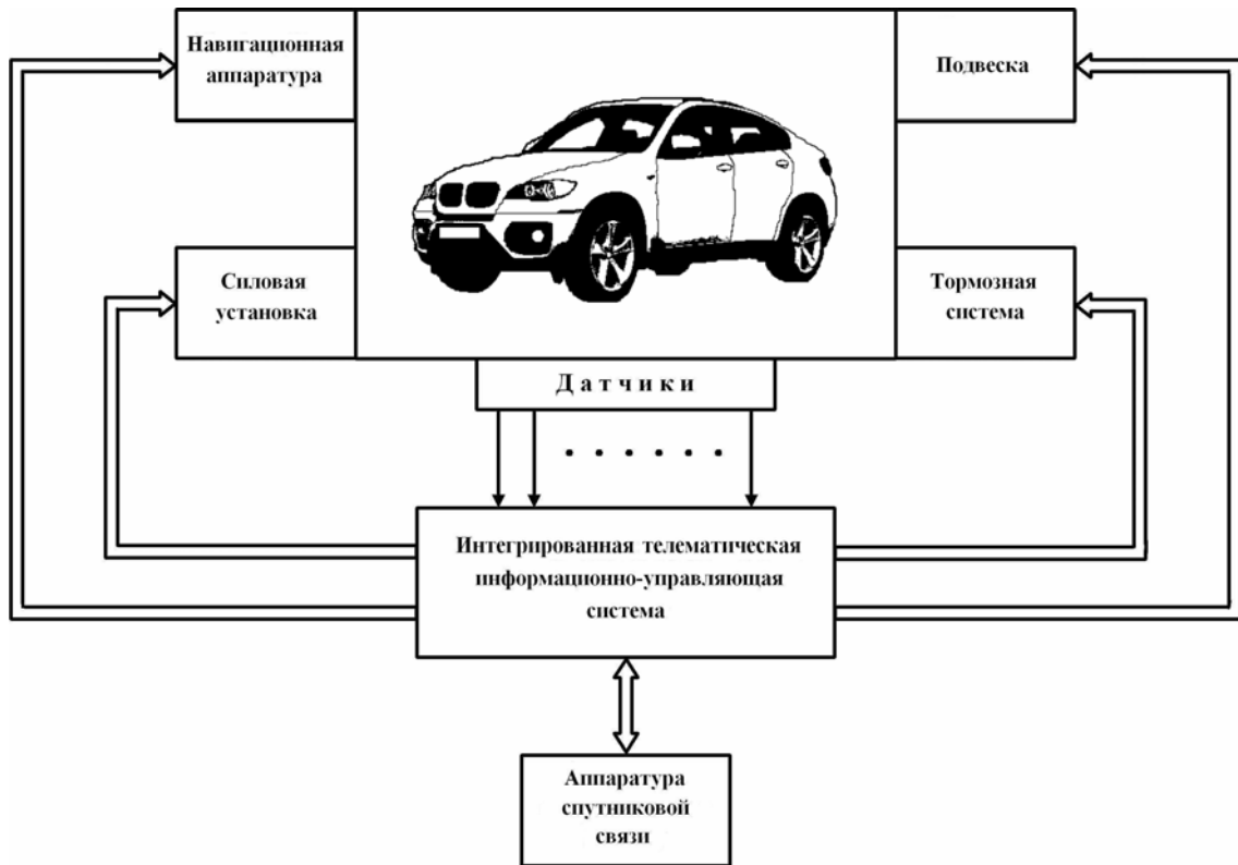
Рис. 1. Пример интеграции основных систем ИУС транспортного средства
