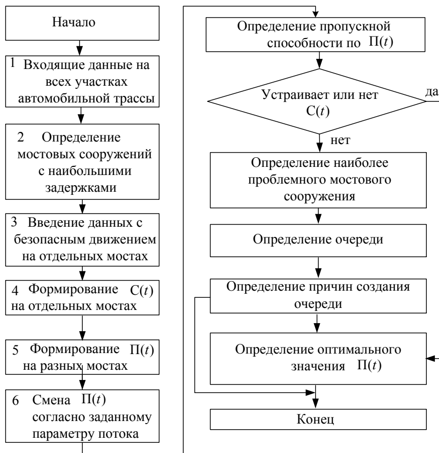
Рис. 2. Блок-схема определения пропускной способности мостовых сооружений
