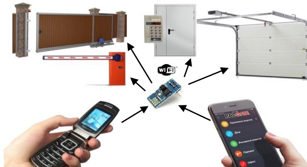
Рисунок 3 - Використання технології безключового доступу для контролю пристроями обмеження доступу
