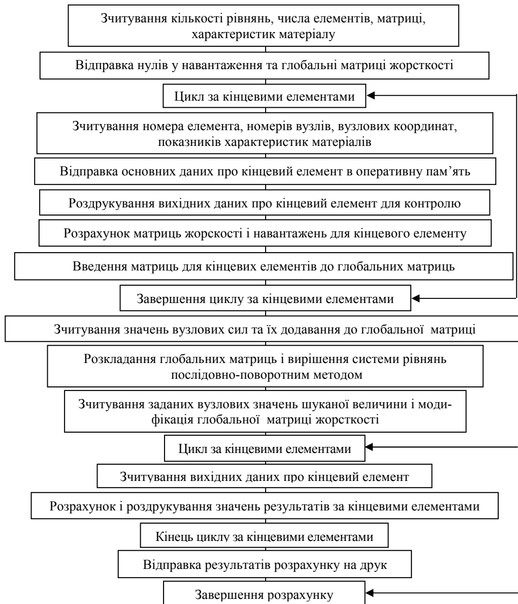
Рис. 1. Блок-схема програми SELENA
