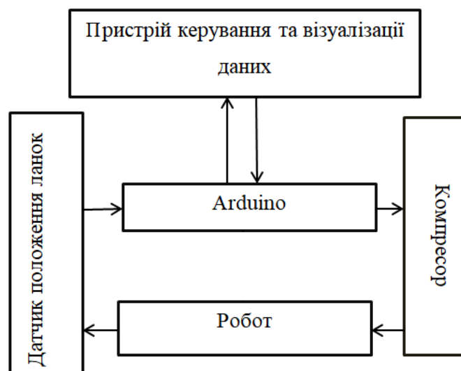
Рисунок 5 – Функціональна схема мікропроцесорної системи керування роботом ПР5-2П
