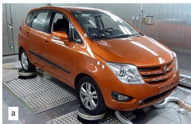
Рис. 1 – Чотирих-стійкові контрольно-випробувальні стенди для перевірки підвіски: а – платформа SERVO 2000; б – система фірми Shenck
