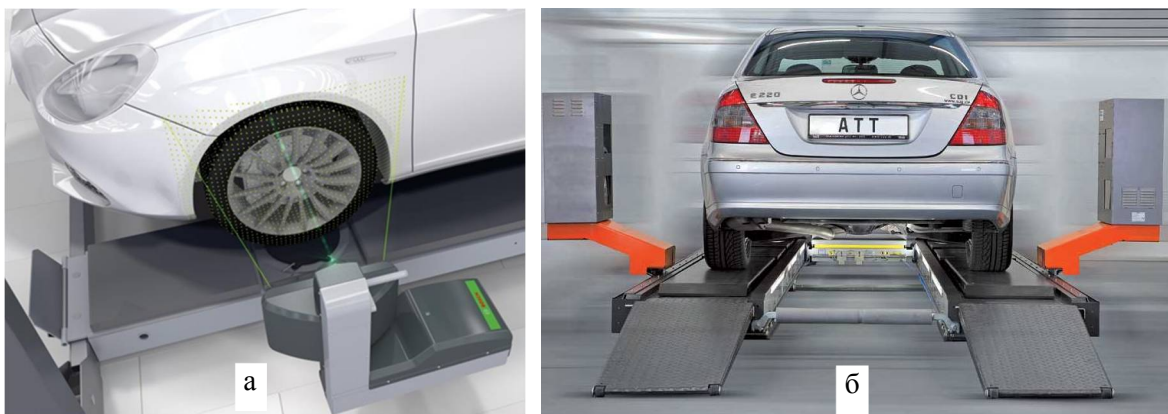
Рис. 3 – Системи позиціонування поверхні коліс на стендах безконтактних вимірювань: а – моделі FWA 9000; б – моделі CURA R 2000 АТТ
