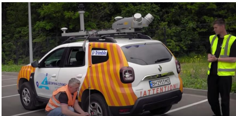
Рисунок 1 – Зовнішній вигляд мобільного лазерного 3D сканеру Trimble MX2
