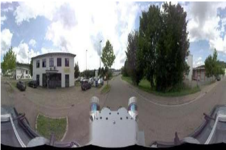
Рисунок 7 – Приклад відображення результатів вимірювань мобільним лазерним сканером Trimble MX2 у панорамного зображення
