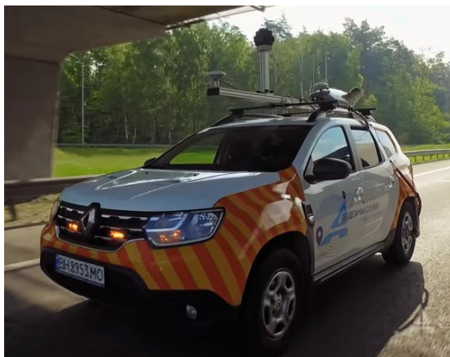
Рисунок 5 – Зовнішній вигляд мобільного лазерного сканеру Trimble MX2 встановленого на автомобіль
