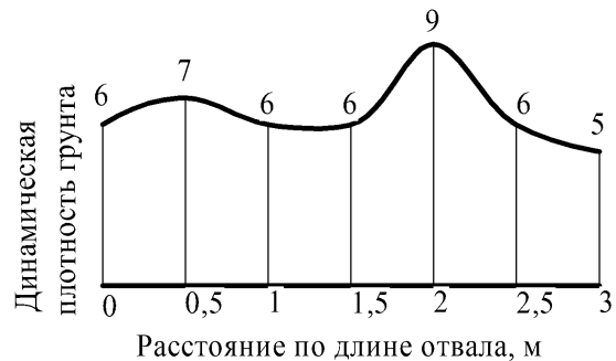
Рис. 2. Изменение динамической плотности грунта по ширине отвала
